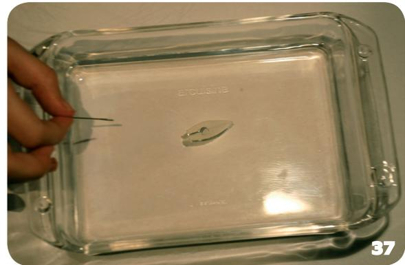
**E**xplication : Lorsque l'huile est déposée à l'aide du chas de l'aiguille dans le trou du bateau, elle va s'étendre instantanément sur la surface de l'eau. Le canal du bateau va canaliser son expansion vers l'arrière. Par réaction, cela va provoquer une poussée du bateau vers l'avant.
